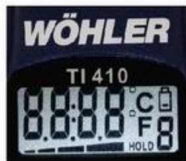
图7: 初始屏幕 (含电池符号, 条状符号, 温度档位, HOLD)
