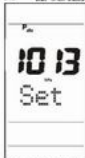
图 12: 默认设置的绝对压力值
