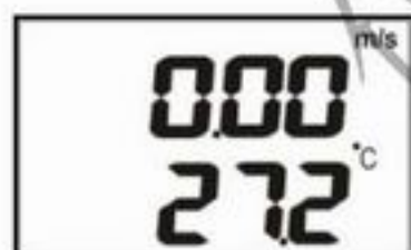
图 6: 流速和空气温度显示
