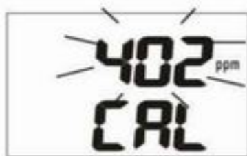
图 19: 校准 CO 2 传感器
