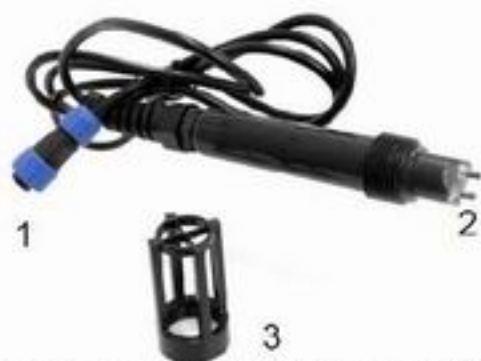
图 13: EC (电导率)探头与主机连接的插头(蓝色) (1)、测量电极 (2) 和探头防护罩 (3)
