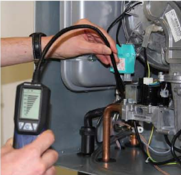
图5: GS 300 一靠近喷嘴, 马上提示报警和显示最高浓度的条形图, “此操作仅用于检查GS 300对甲烷或丙烷气体的反应是否灵敏, 非专业人员切勿模仿”
