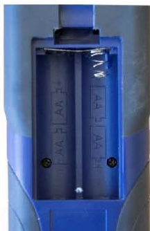
图6: 主机背面的电池舱
