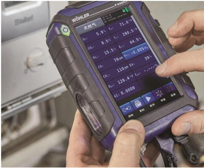
高分辨率 5 寸触摸屏，单屏幕同时显示全部 14 个被测数值
