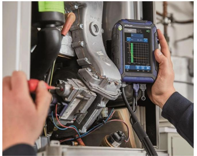
调试向导为供热技术员调节燃烧器提供实时准确的调节反馈信息
