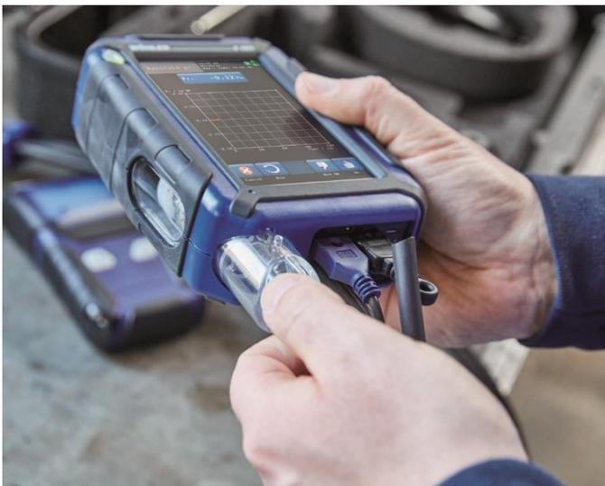
维护简便，冷凝槽可轻易拆卸更换
